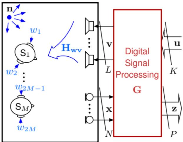
$$\begin{aligned} \begin{pmatrix} v \\ z \end{pmatrix} &= \mathbf{G} * \begin{pmatrix} u \\ x \end{pmatrix} \\ &= \begin{pmatrix} G_{vu} & G_{vx} \\ G_{zu} & G_{zx} \end{pmatrix} * \begin{pmatrix} u \\ x \end{pmatrix} \end{aligned}$$
